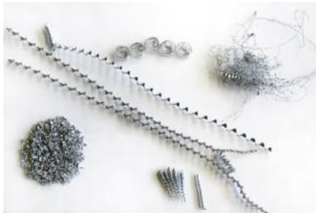
Bild 3: Versuch zur Spanbildung bleifreier und bleihaltiger Aluminiumwerkstoffe.
